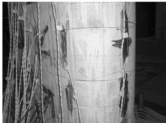
图 6 S-2 墩裂缝破坏
