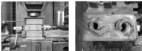
(a)受剪砖被推出 (b)凸口被剪坏 图3 剪切破坏形态
