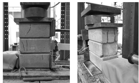
(a)受剪砖难被推出 (b)受剪面被压入
