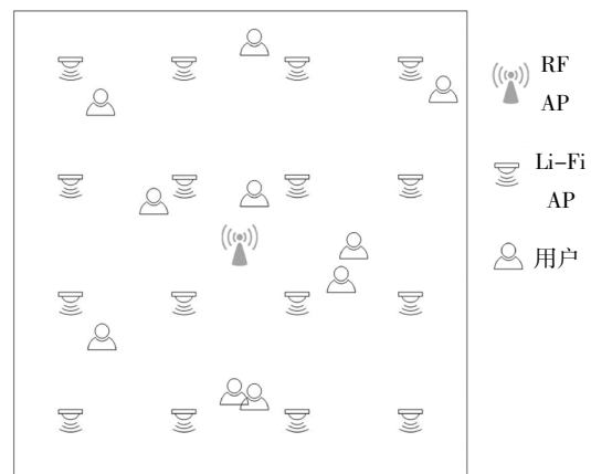
图1 室内Li-Fi和RF的混合网络模型图
