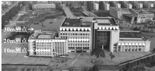
图6 建筑物控制点和检查点布置方案
