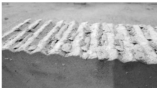
图 6 剪切破坏后软岩试样图片
