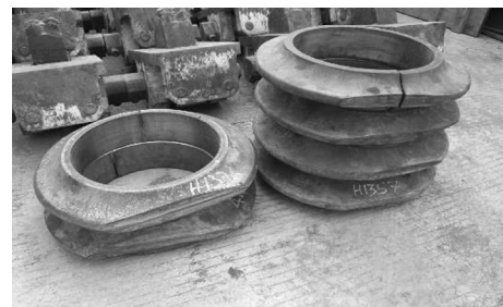
图5 盘形滚刀的破岩损耗
