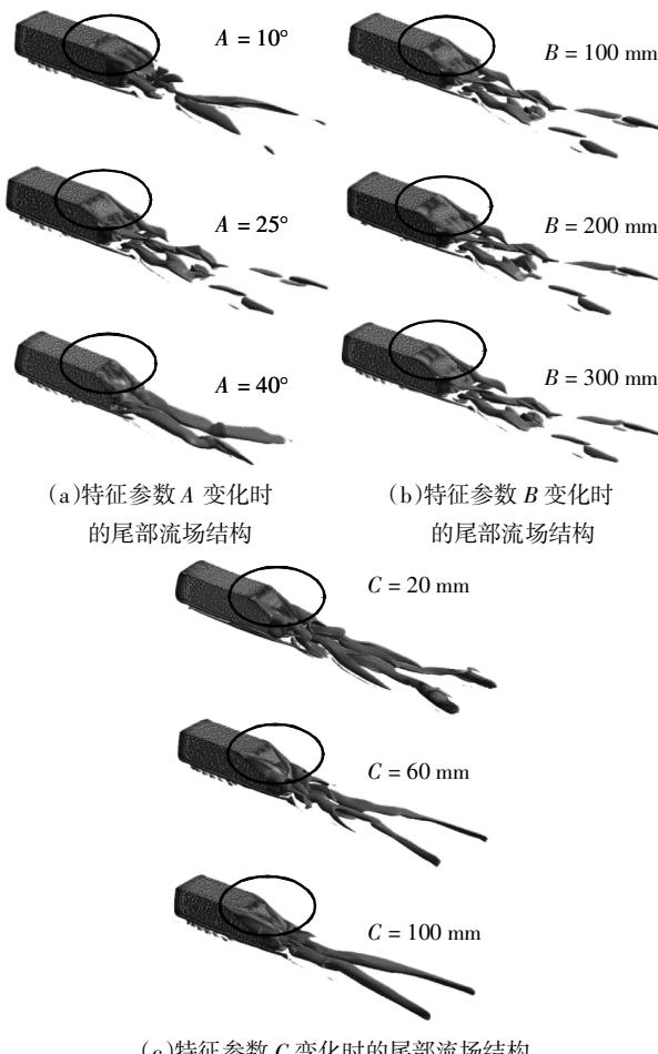
图 8 单一特征参数变化时的尾部流场结构
