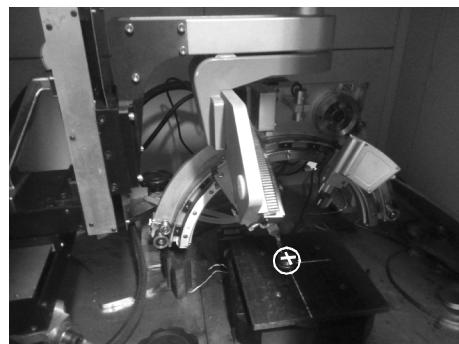
图 7 X 射线应力测定仪(X-350A)
