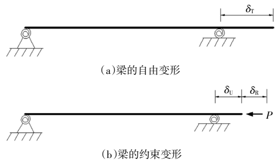
图 7 梁的位移平衡图
