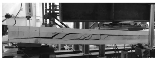
图 2 三层 CLT 楼板破坏图
