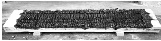
图4 CLT 楼板受火后照片
