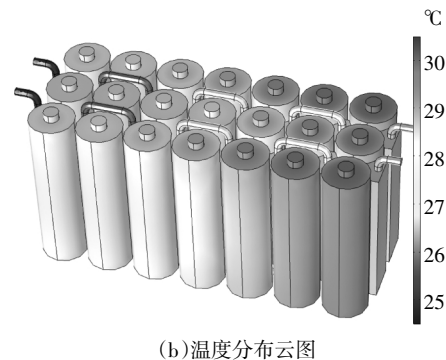
(a)冷却系统结构图 (b)温度分布云图 图 13 铝柱高度与截面的组合方式下的冷却系统结构图和温度分布云图 Fig.13 Cooling system structure diagram and temperature distribution cloud diagram under the combination of aluminum column height and section
