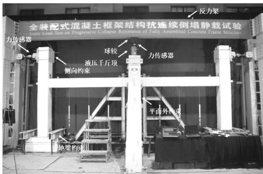
图 4 试验加载装置
