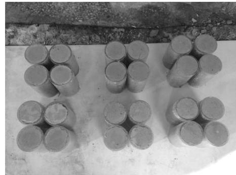
图 2 部分充填体试件
