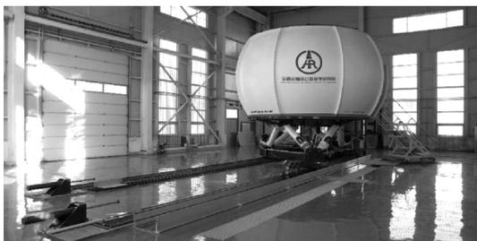
图 1 RADS 型 8 自由度全景驾驶模拟系统
