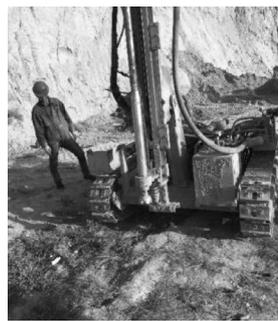
(b)履带式潜孔钻机
