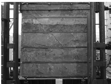
(d) 试件 SW-4 墙面裂缝分布
