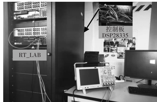
图5 基于 RT_LAB 的实验系统平台
