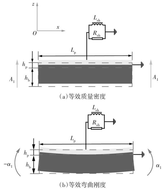
图 2 等效参数求解原理示意图
