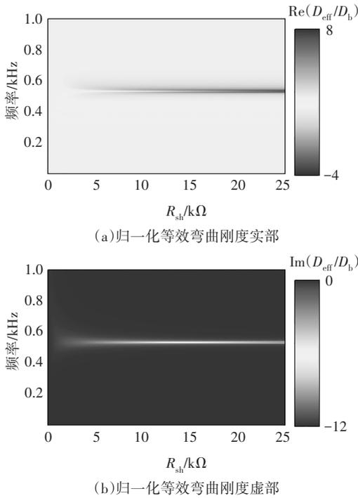
图7 谐振频率 $f_0=500$  Hz时损耗单元归一化等效弯曲刚度与分流电阻 $R_{sh}$ 、弯曲波频率的关系
