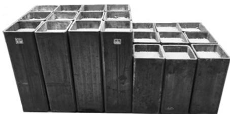
图3 推出后试件
