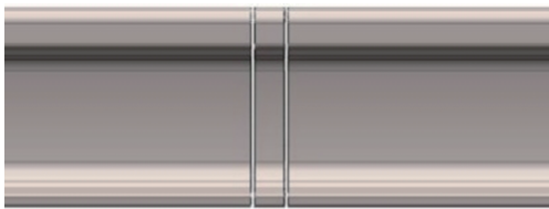
图 5 气隙缺陷局部模型 Fig.5 Local model of gap defect
